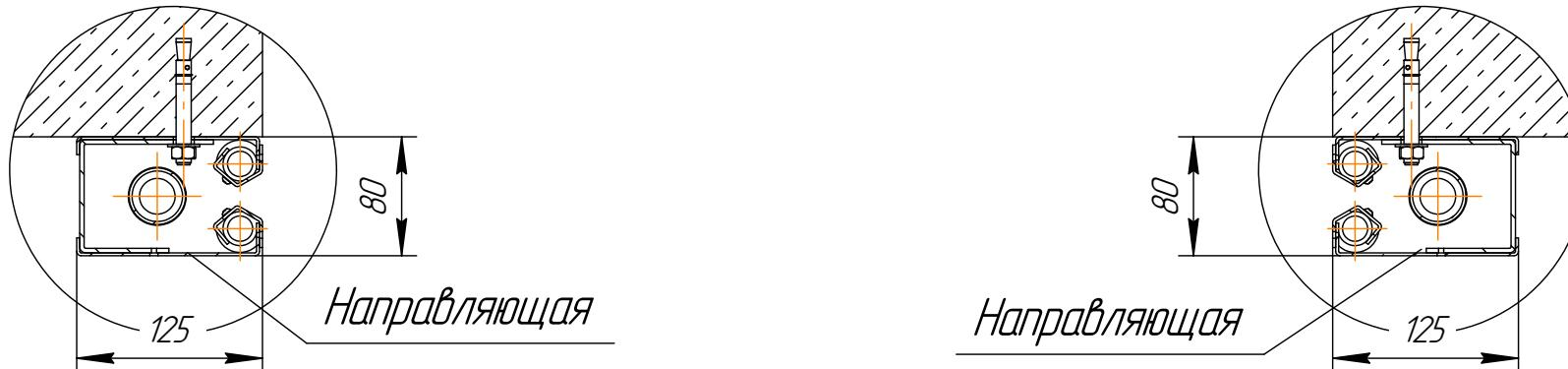
Вес шторы приходится на две боковые крышки, расположенные слева и справа и поддерживающие консоли, расположенные с шагом 1500мм. Вес погонного метра короба составляет 30 кг, вес погонного метра направляющих шин 13 кг. К месту расположения блока управления подвести:
